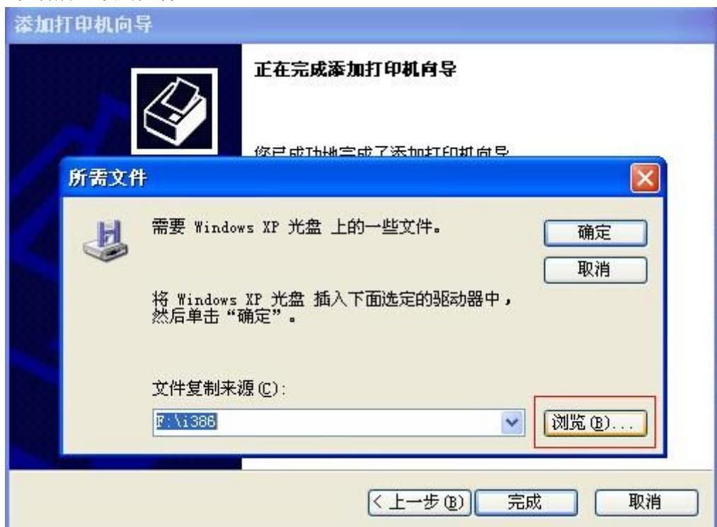
解决方式：手动查找系统所缺失的文件，在打印机驱动安装文件目录下，我们提供了这些文件。点击“浏览”按钮，如上面图中红框标识所示，指定到提供的打印机驱动安装文件路径。首先，必须知道自己电脑的操作系统是多少位的系统（在电脑桌面上，Windows XP 右键“我的电脑”，Windows 7 “计算机”，在弹出的系统信息里面可以看出自己电脑的操作系统信息），其次选择对应的驱动程序文件，如果是 32 位系统，选择驱动安装文件夹路径下的 i386 文件夹，如果是 64 位操作系统，选择驱动安装文件夹路径下的 amd64 文件夹。
