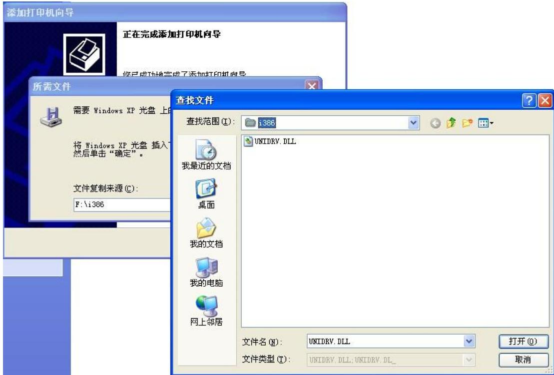
范例电脑的操作系统是 32 位，假设驱动程序安装文件路径是：E:\打印机光盘样例\driver\_setup\driver\ SamplePrinter。那么点击“浏览”按钮，指定缺失文件查找路径到：E:\打印机光盘样例\driver\_setup\driver\ SamplePrinter \i386，然后点击“确定”按钮，直到完成驱动安装。
