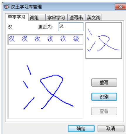
在书写区内工整重写当前字，点“识别”按钮，选择正确的识别结果输入到“更正为”栏内，也可以用别的输入法输入更正字。单击“确定”按钮，系统就将右上方用户笔迹与当前的更正字进行学习，以后系统就可以识别您的这种书写习惯了。
