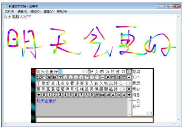
全屏幕多字书写窗口的上面是一个编辑区和候选区，单击编辑区中某个字，在弹出的窗口内可选择正确的候选字、同音字、联想字来替换，或使用拆分合并功能 重新识别，修改更正后再一次发送至编辑窗口内进行替换。候选区内所显示的内容为多字输入时，最后一个字符的候选字。
