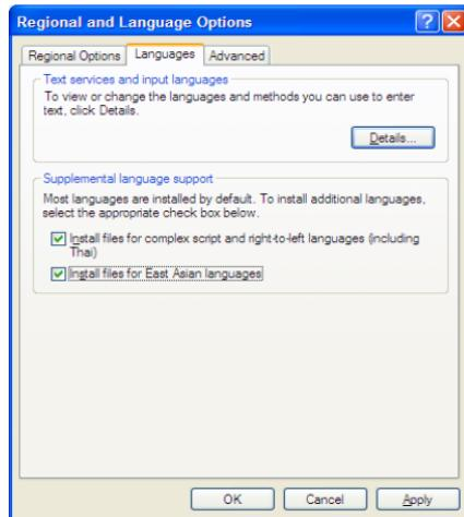
根据提示，安装相关文件并重新启动计算机，即可支持正确显示中文字符。
