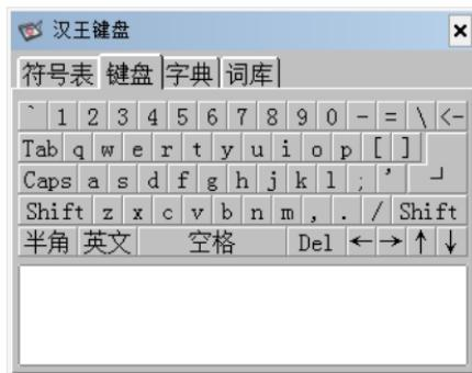
单击按钮 [英文] 使其变成 [拼音] 时，此时可通过点击键盘上的字母以拼音方式输入汉字，然后在下面的文字区域选择。输错拼音可以单击退格键 “←” 来删除错误拼音。
