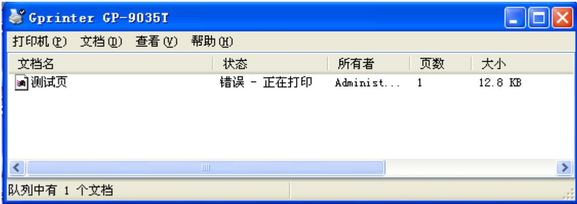
回到打印机属性的“端口”选项卡中，勾选另外一个 USB 虚拟端口，点击右下角“应用”，等待一下，测试页任务会重新启动，如果端口对应上，则任务会消失并且打印机会打印动作，如果仍然是错误则重复上述勾选操作直到打印任务完成。
