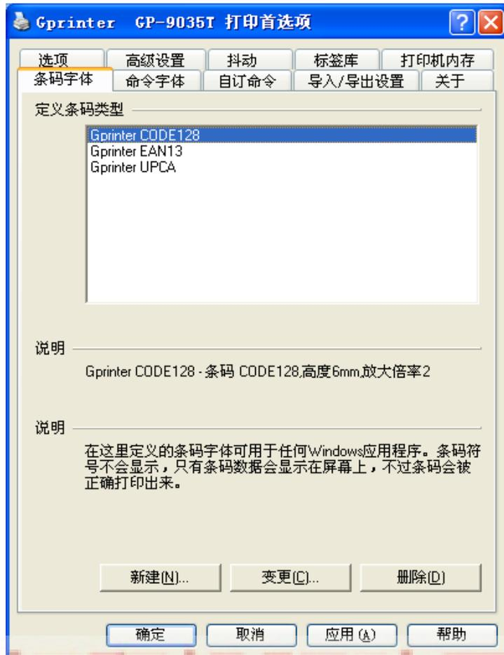
可以新建或者变更删除定义的条码字体，参数包括了条码的类型，方向，尺寸，识别码，宽窄比等。命令字体也有类似调整。如下图：
