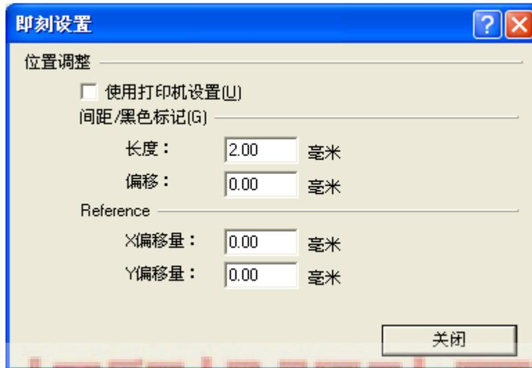
“间距/黑色标记”一栏中调整“长度”参数，根据用户使用的标签纸上标签和标签间的间隙高度来调整此参数。
