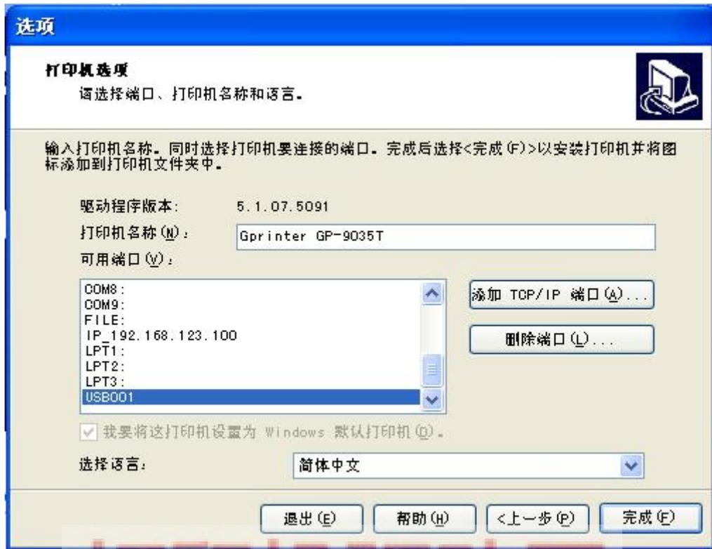
若使用网络端口请选择添加 TCP/IP 端口，如下步骤：
