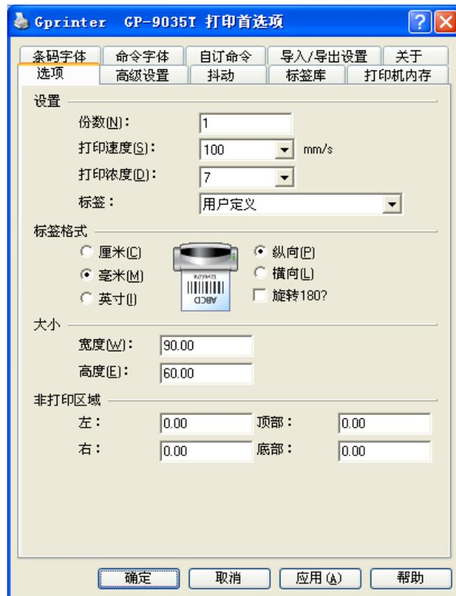
“打印速度”和“打印浓度”根据实际使用的纸张和耗材调整，尤其是使用热转打印方式时，速度和浓度的配对使用对打印效果有影响。在“大小”一栏输入实际使用纸张或者打印范围的尺寸，如果是标签纸则表示可打印幅面的大小而不包括衬纸。
