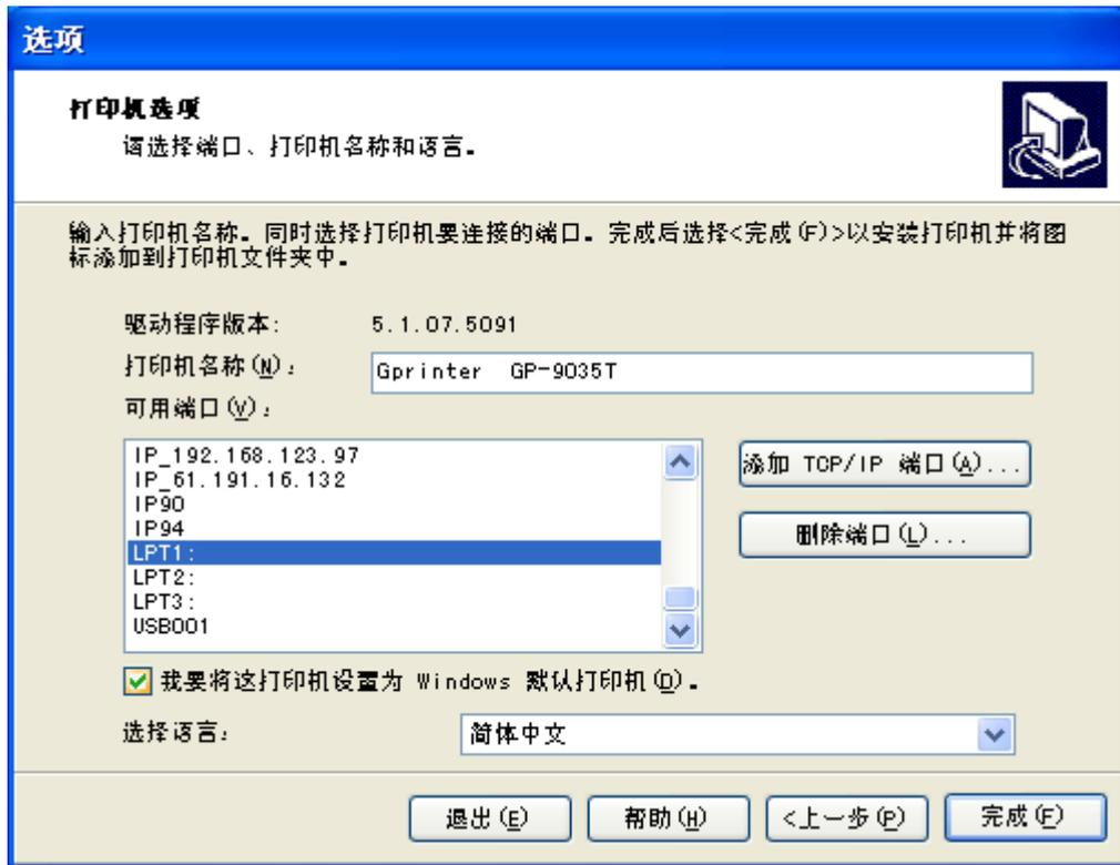
串口线连接请选择 COM，根据机器有否扩展选择端口。
