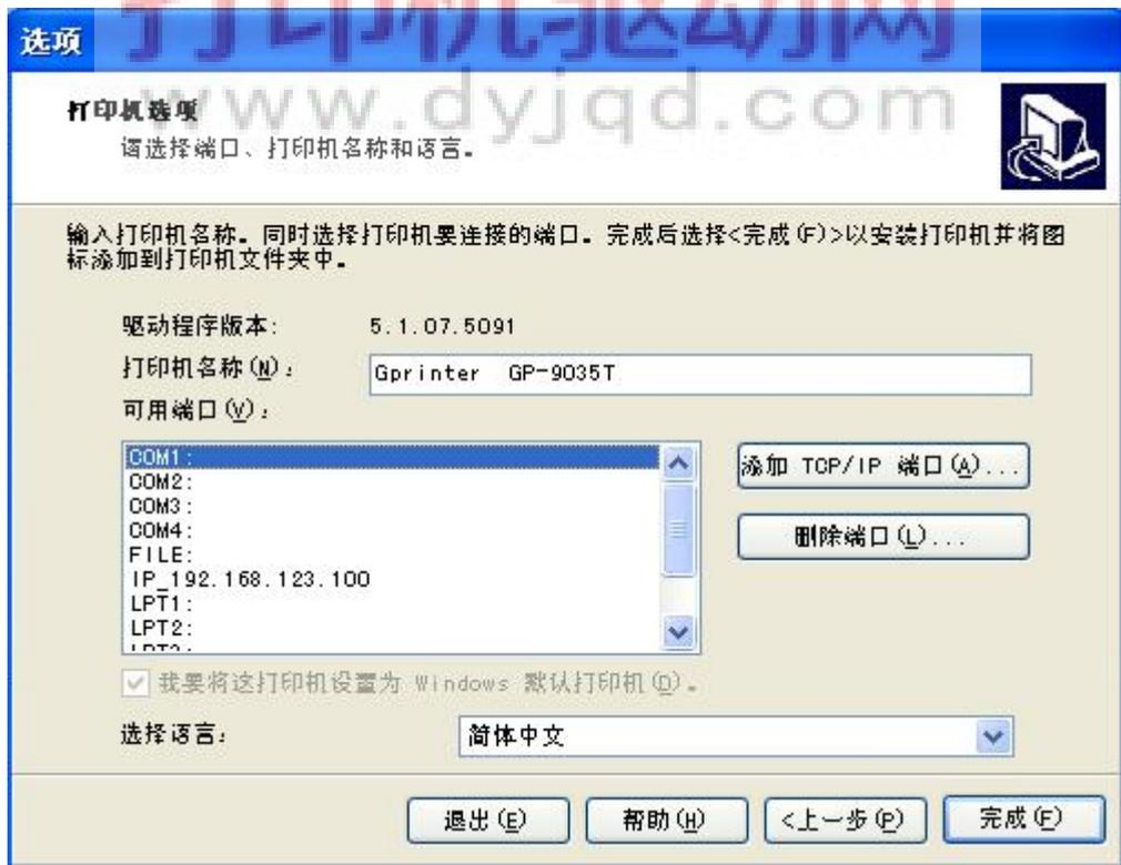
USB 线连接请选择 USB，请注意因为 USB 接口为系统虚拟打印端口，实际操作过程中需要确保打印机 USB 线连接上并打开打印机电源。如果一台电脑在安装多台连接 USB 线的打印机时，有可能出现多个 USB 端口，如 USB001，USB002……USB005……等，如果在完成驱动安装后不能打印需要进行端口调整。
