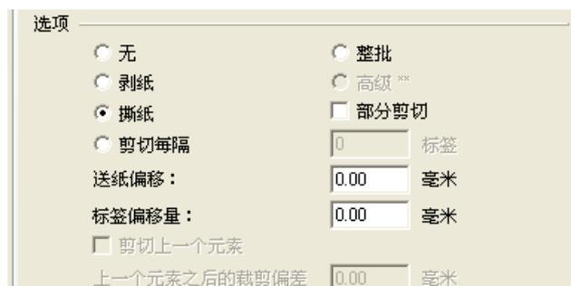
如果标签内容除了上下偏外还存在左右偏可以选择打印机“属性”-----“打印首选项”-----“高级设置”-----“其他”，设置坐标参考点偏移。如果标签方向只选择了纵向，则坐标原点在出纸方向的左上角，如果纵向旋转了 180 度则原点在出纸方向的右下角，同理如果只选择横向，则原点在出纸方向的右上角，横向 180 度则在出纸方向的左下角。此参数只接受正值，所以调整时请谨慎选择方向和偏移量，尽量和上述标签偏移配合使用，达到理想的效果。
