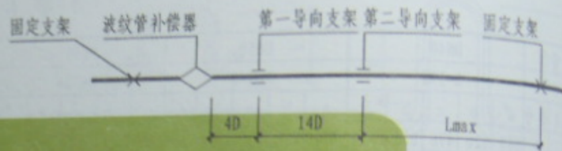
轴向式波纹管补偿器固定支架与导向支架分布示意图
