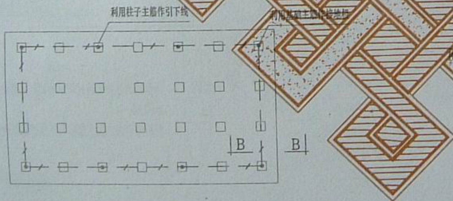
无防水层底板避雷接地极平面图
