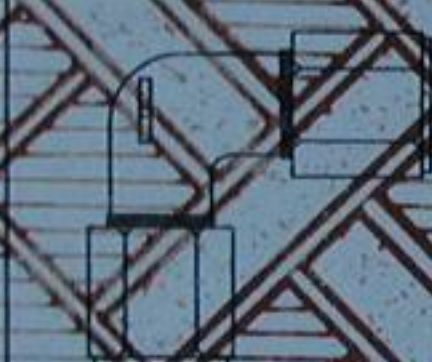
加长型内螺纹弯头/加长型龙头弯 (一头接开泰管另一头金属管内螺纹)
