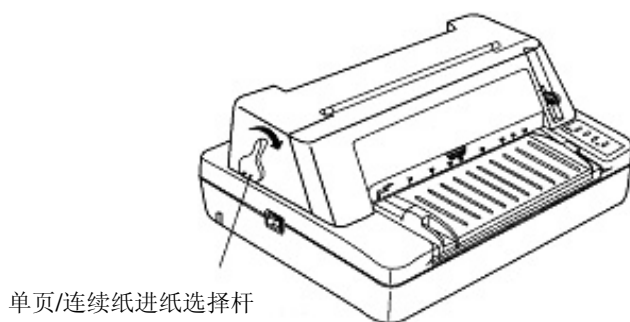
图 3-6 设定单页/连续纸进纸选择杆位置（连续纸）
