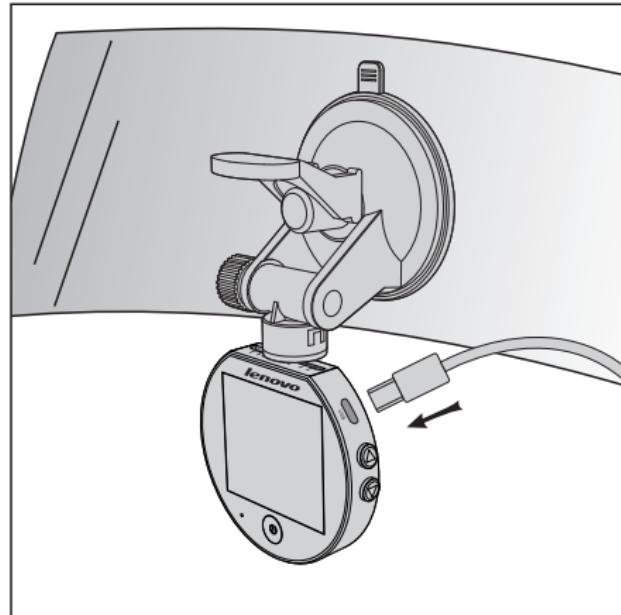
④ 将车充USB端连接主机。
