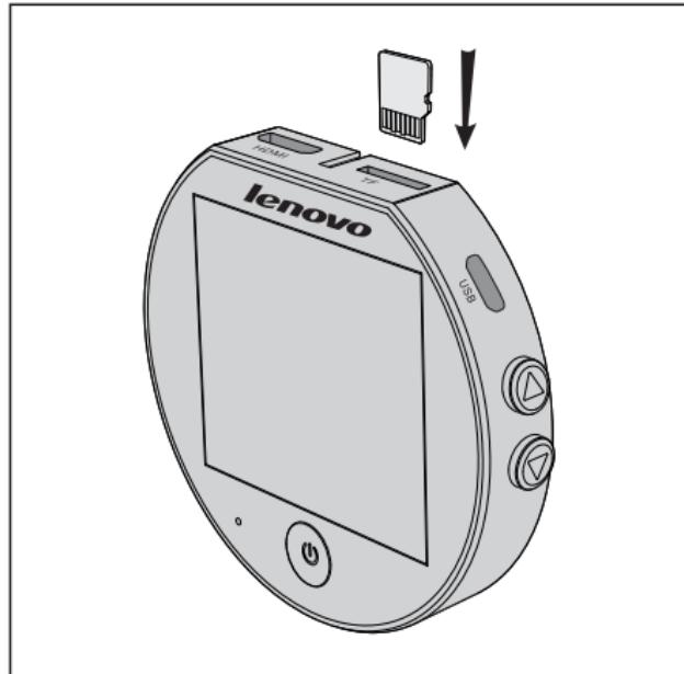
① 首先将存储卡装入主机，注意存储卡方向，避免造成存储卡或主机损坏。
