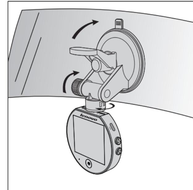
③ 将托架安装在挡风玻璃上。并可对各方向角度进行微调。如图所示。
