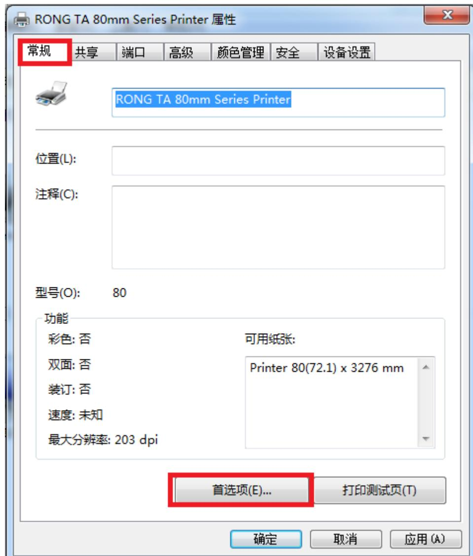
2、驱动已默认设置自动切纸及开钱箱，如需变更设置，请按如下操作：选择“纸张/质量”，其中“纸张来源”选项为选择是否切纸，如 Report (Cut) 为自动切纸，打印测试页完后，切刀会自动进行切纸。“媒体”选项为选择钱箱是否工作。选择完成后，点击“应用”、“确定”完成设置。
