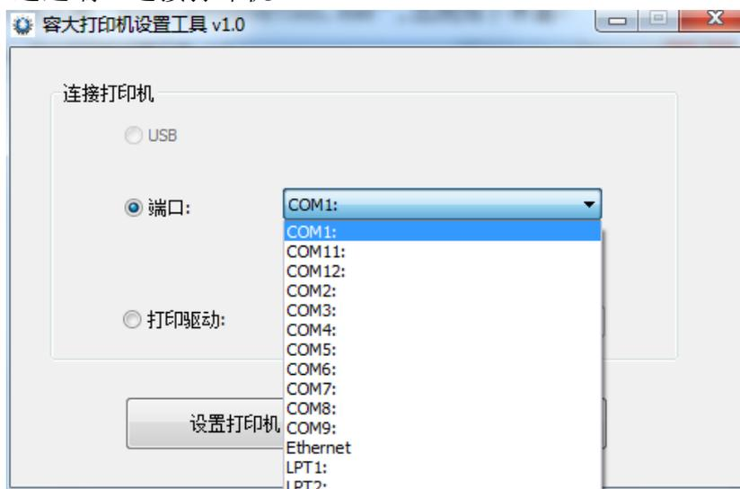
端口可以通过串口、网口以及并口，进行“配置端口”后，连接打印机，然后进行“设置打印机”或者进行程序“下载”。
