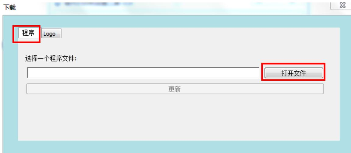
1. 进行“程序”更新。点击“打开文件”，选择对应的程序路径，点击“更新”后，更新程序。
