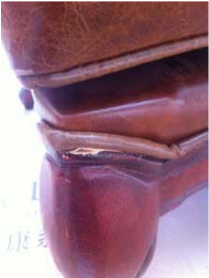
家具的腿脚处由于造型特殊，此处的软包有没有闭合是检查的重点。
