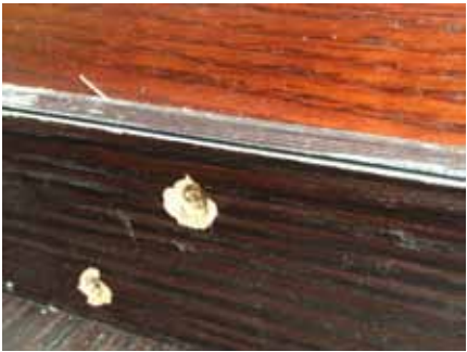
这个板面由于采用合成材料制作，螺丝周围爆边很严重。
