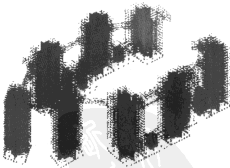
图 26-4 连体结构整体分析模型
