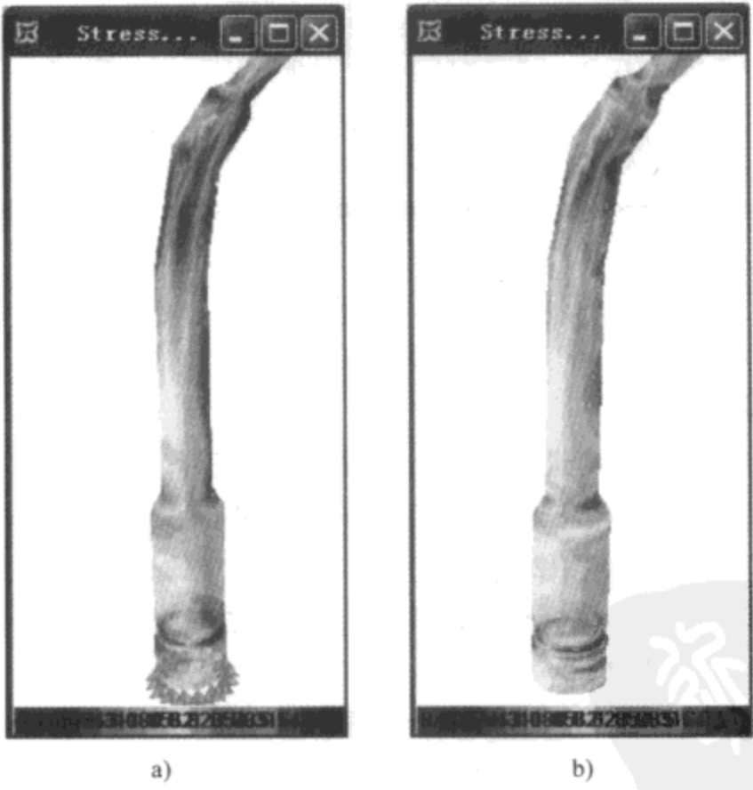
图 28-49 竖向地震作用下设备正应力 a) M2; b) M3
