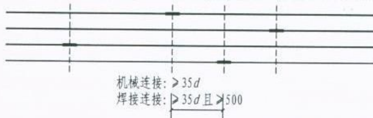
图10.3.1-2 钢筋机械连接及焊接
