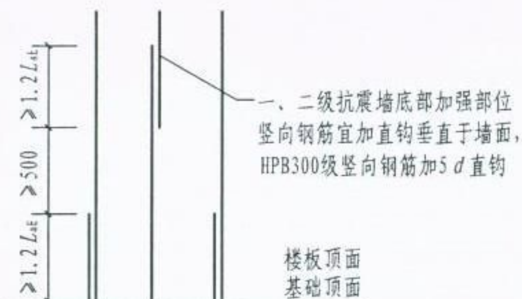
墙体竖向分布钢筋搭接（一）
