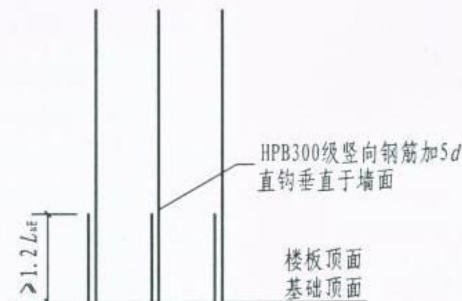
墙体竖向分布钢筋搭接（二）
