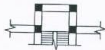
楼梯间突出时，构造柱布置示意图
