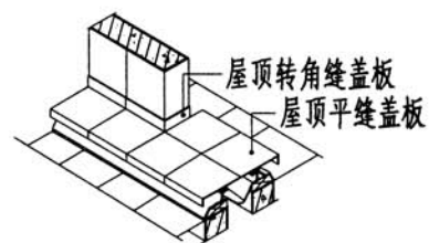
屋顶平缝与屋顶转角连接图
