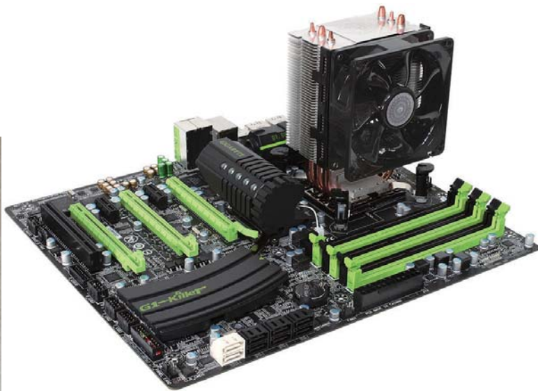
■ 当前塔式侧吹是CPU散热器的主流散热设计,而这种结构对机箱风道的要求恰恰极高,同一款散热器在不同风道中展现的性能差距甚大。
