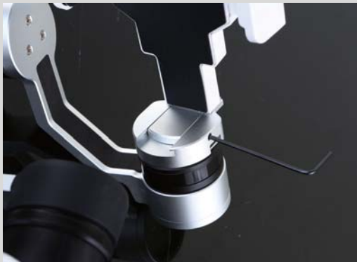
>> 除了用配重块来平衡重量,你还可以调整云台臂支点的位置。
