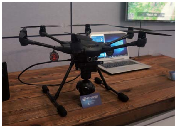
>> 配备实感摄像头的 Typhoon H 无人机,不需要任何人的控制,就可以轻松地,视觉性地跟随主人飞行。
