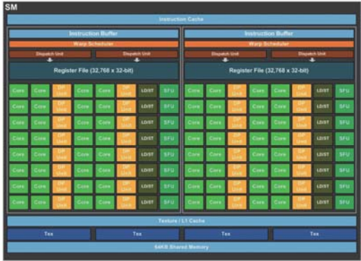
■ GP100的SM架构图，绿色的是FP32 CUDA Core，橙色则是FP64 CUDA Core，比例是2:1。此外还有缓存、寄存器等。
