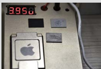
更换的存储芯片需要使用硬盘序列号读写设备将原芯片信息写入，才能够正常使用。
