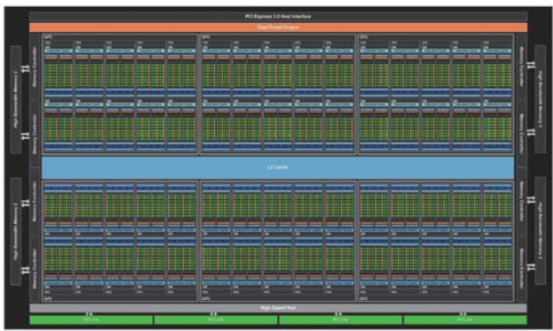
■ GP100架构图，可见6个GPC下辖了60个SM单元。
