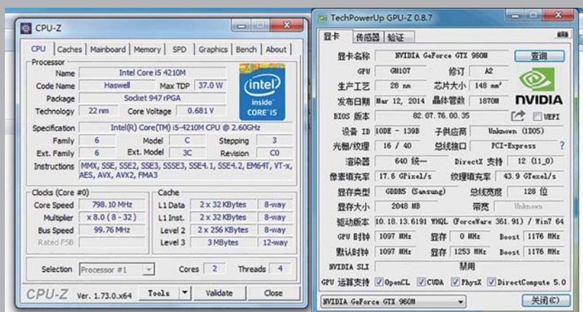
■ 处理器和显卡参数一览,抛开成见,其实上一代(Haswell)的处理器性能并不差,而2GB显存对于GTX 960M显卡以及1080p分辨率下不少单机游戏和大部分网游而言已经够用,整体而言是一个比较务实的处理器和显卡配置。
