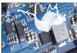
>> 奥睿科T1采用了来自MPS的MP2636充放电多合一管理IC
