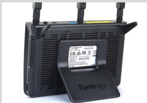
>> 除了底部用螺丝固定的脚架，RT1900ac还配备了一个立式支架，可拆卸式设计，可以让路由器直立放置，节省桌面空间。
