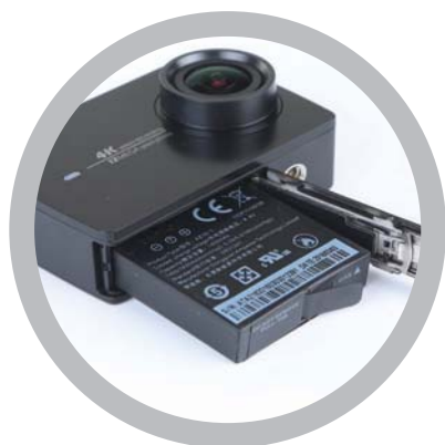
机身底部为电池仓、TF存储卡，并且还配备了自拍杆接口。
