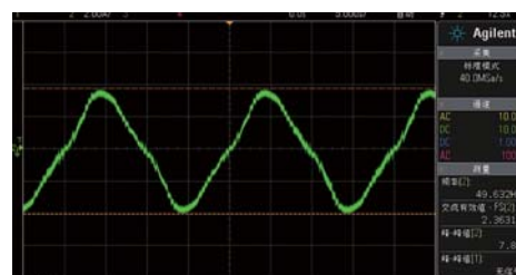
■ Tt SMART DPS G 12V/40A输入电流波形
