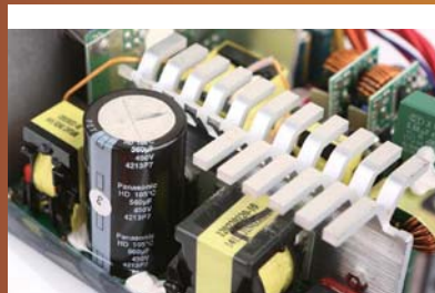
采用了松下HDD系列的560uF,450V电容
