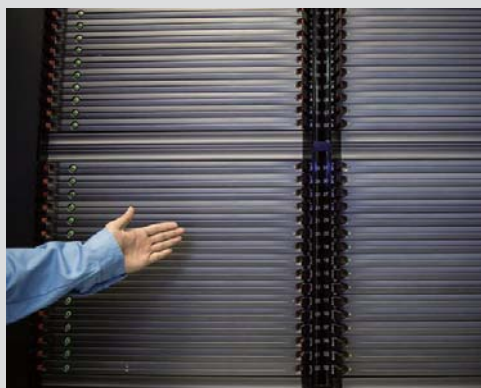
■ 神威·太湖之光超级计算机的运算节点板与机身上的监控面板
