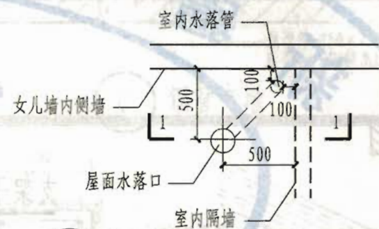
2 平直处女儿墙水落口示意
