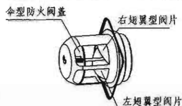
全金属羽翼伞型导流式防火止回阀竖向安装示意图
