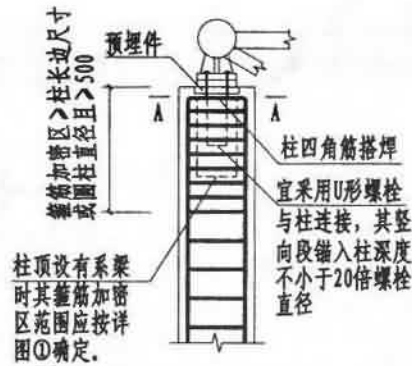
3 顶部为网架或屋架时的柱顶构造
