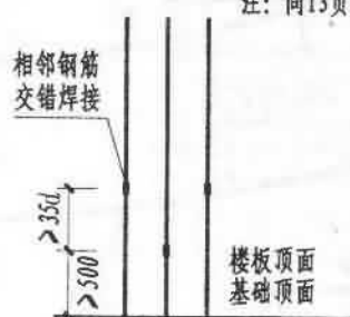
⑥ 剪力墙边缘构件竖向钢筋连接构造
