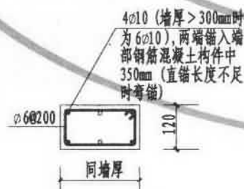
砌体填充外墙拉结构件立面示意图
