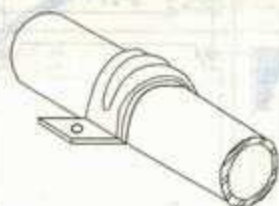
鞍形管卡安装示意
