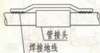
金属导管接头做法
