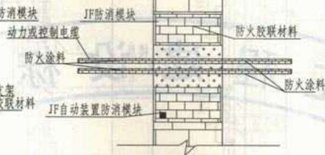
穿墙孔洞封堵
