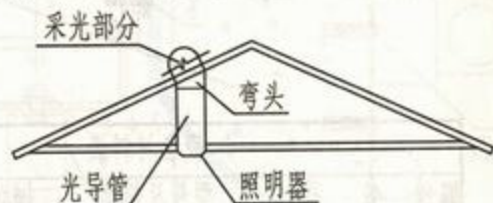
天然光导管系统的构成图
