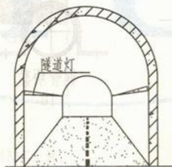
隧道灯安装示意图
