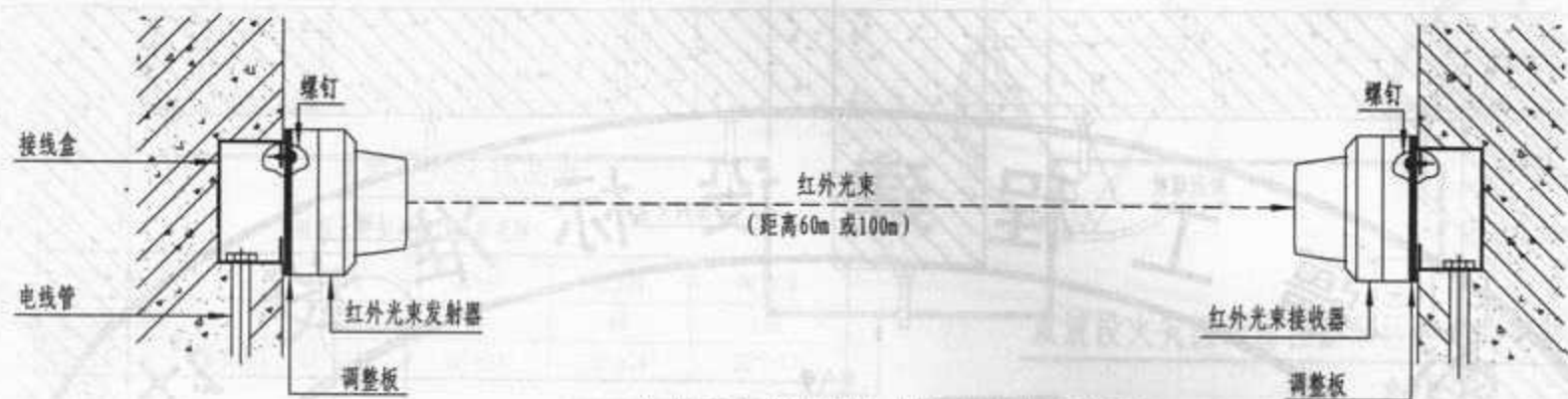
红外光束探测器在侧墙上安装示意图
