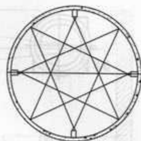
双波段火灾探测器在圆形区域内的安装方式
