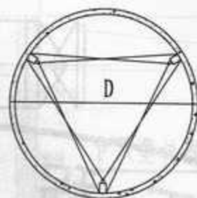
双波段火灾探测器在圆形区域内的安装方式
