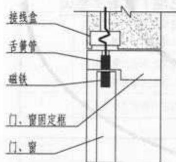
磁开关安装示意图
