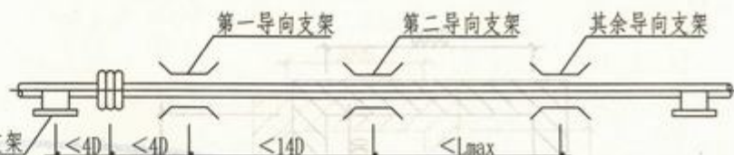
轴向式波纹伸缩节固定支架和导向管架的分布示意图
