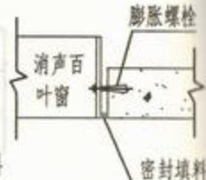
膨胀螺栓连接
