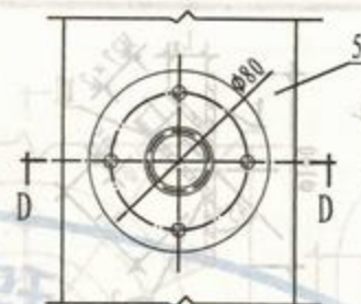
在垂直矩形风管上水平安装
