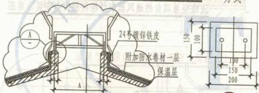
流线型屋顶自然通风器混凝土屋脊上安装
