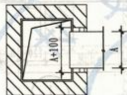
A 土建竖风道水平风管连接
