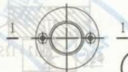
圆形不保温竖向风管吊架
