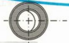
(2) 玻璃钢薄板或铝箔玻璃钢薄板保护层
