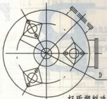
轻质塑料珠压力滤器基础图
