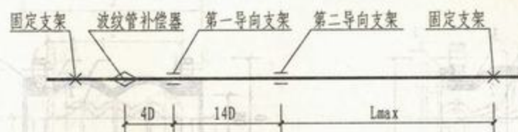
轴向式波纹管补偿器固定支架与导向支架分布示意图
