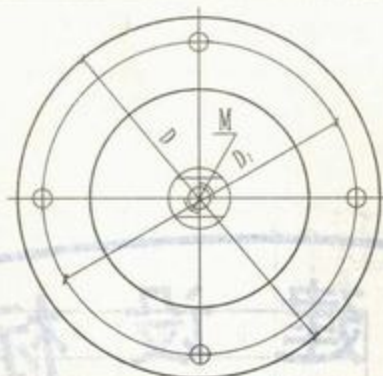
JSD型橡胶隔振器平面图
