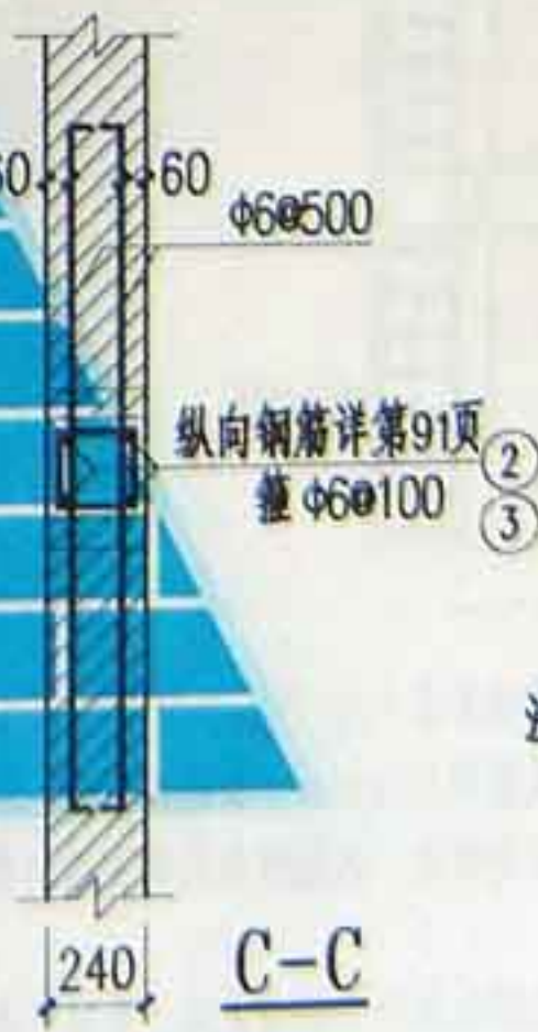
屋盖及突出屋面屋顶间部分的节点图(二)
