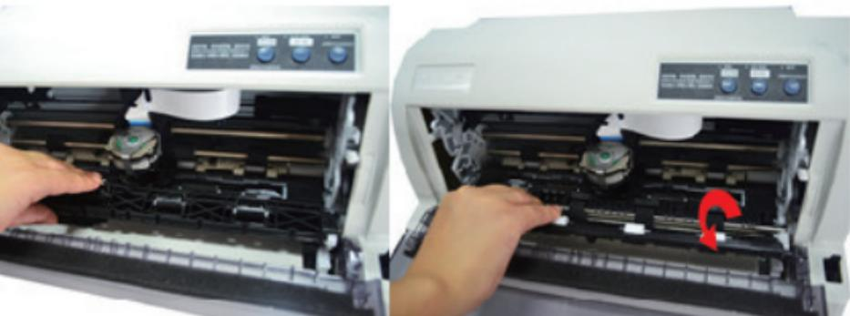
2.向自己方向水平拉动搓纸板，向外旋转使其成打开状态；
