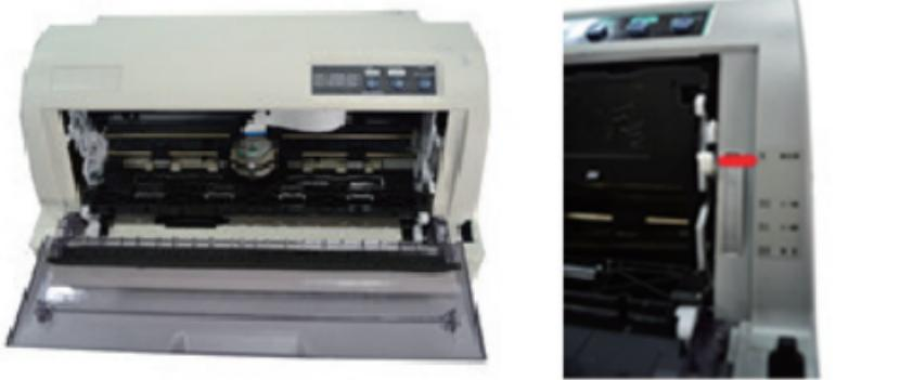
1.关闭打印机打开透明盖；将档位调节杆拨到“N”的位置；
