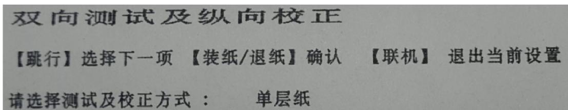
3. 或者再按**常速/高速键**, 单层纸将被替代, 出现多层纸选择, 如图: (图示 2)
