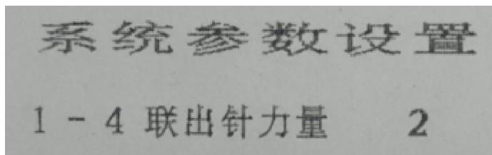
4. 每按一次**常速/高速键**更改此项设置值并打印新设置值，设置值的数值越大表示出针力量越大，直到您看到自己满意的参数值，按**进纸/退纸键**进入下一项调整，以下系列例图演示了此步骤的基本过程。
