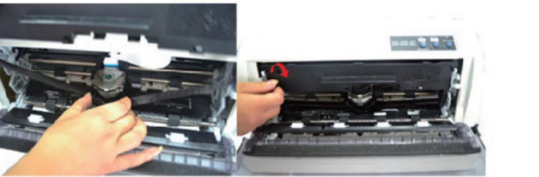
4.捏住色带导带器将两边卡爪沿字车斜插到打印头两边固定孔中，色带必须卡到打印头和色带导片之间！转动旋钮使其不能卷曲褶皱；
