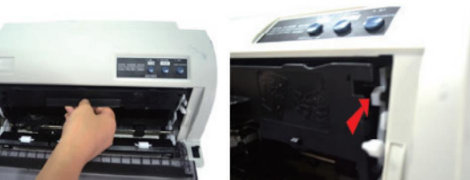
5.手拿色带盒把手，水平推入机器中，使卡槽卡入机器中；
