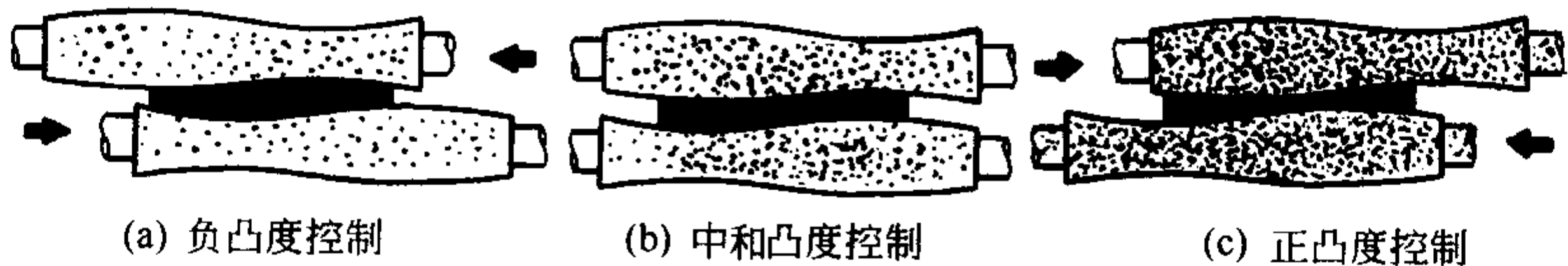
图 6-31 CVC 轧机的工作原理
